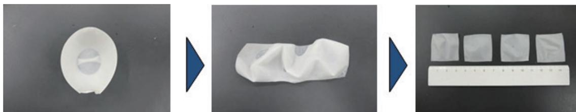
図-1. 卵殻膜の切り出し手順と約 3×3 cm に整形した膜試料
